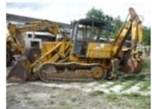
Quando è utilizzata come caricatore, normalmente con la benna, la macchina effettua il carico con un movimento in avanti secondo un ciclo di lavoro del caricatore che comprende un riempimento, un sollevamento, un trasporto e uno scarico del materiale.
