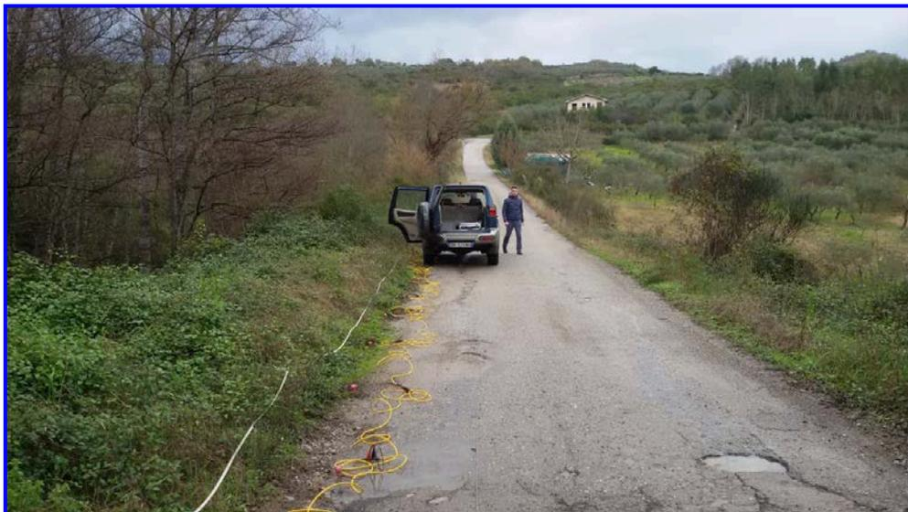
**Fig. 2 – Stendimento per prospezione sismica messo in opera n.2.**
